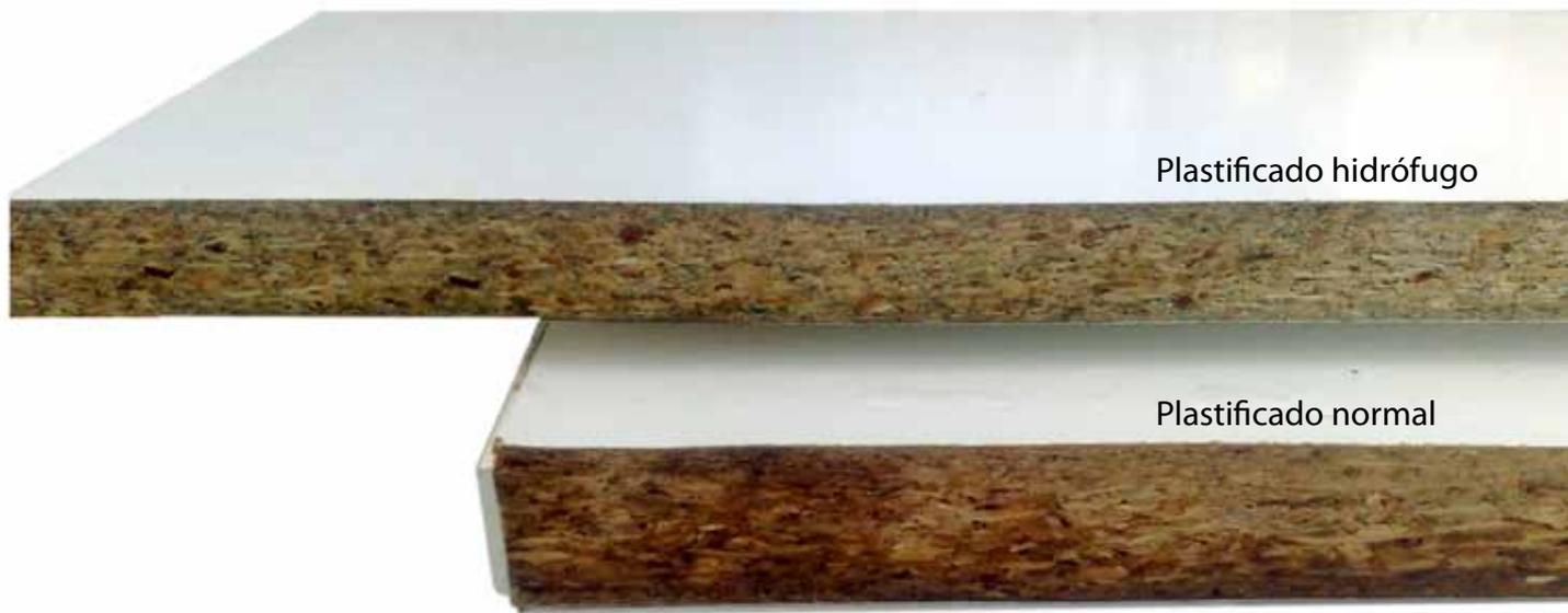
Resultado de prueba realizada con tableros sumergidos en agua varias horas.
